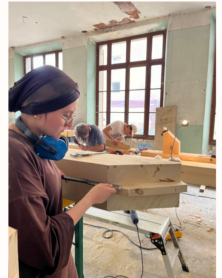
stagiaire en train de faire les finitions à l'aide d'un ciseaux à bois du tenon
