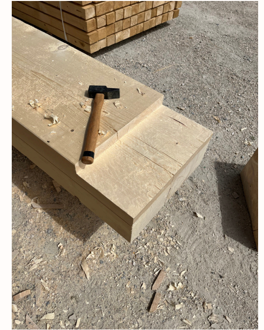
les étapes de découpe du tenon de l'enfourchement
